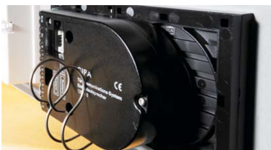
Alle handelsüblichen Gegenlautsprecher werden durch einfaches Klemmen im patentierten Renz-Sprechfeldadapter montiert. Alternativ ist eine Montage mittels Kabelbindern möglich. Bei schwer zugänglichen Stellen kann der Adapter einfach abgeklipst und der Lautsprecher außerhalb montiert werden.
