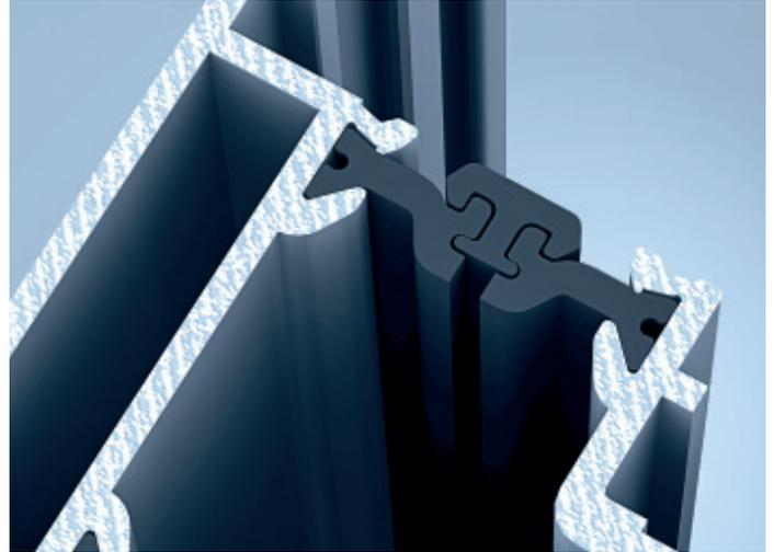
Die heroal Türsysteme D 72 bieten durch drei innovative Fertigungsschritte wirksamen Schutz vor dem Bimetalleffekt, bei dem große Temperaturunterschiede zwischen Innen- und Außenbereich Verformungen am Flügelrahmen verursachen.
